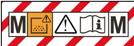
Das Gerät ist zum Saugen für Stäube bis Staubklasse M geeignet.
