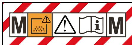
Apparatet kan brukes til suging av støv opp til støvklasse M.
