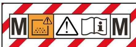
Maskinen er beregnet til opsugning af støv indtil støvkasse M.
