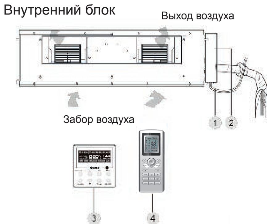
1 — кабель питания; 2 — электрическая коробка; 3 — проводной пульт управления; 4 — беспроводной пульт управления;
