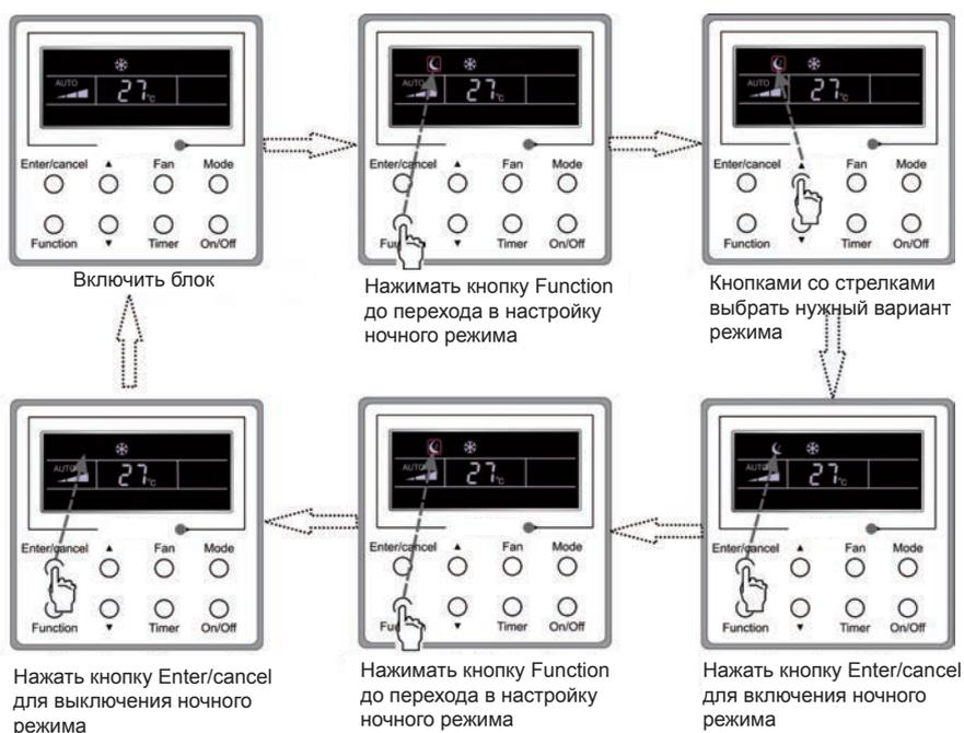
Рис. 10. Последовательность включения и выключения ночного режима
