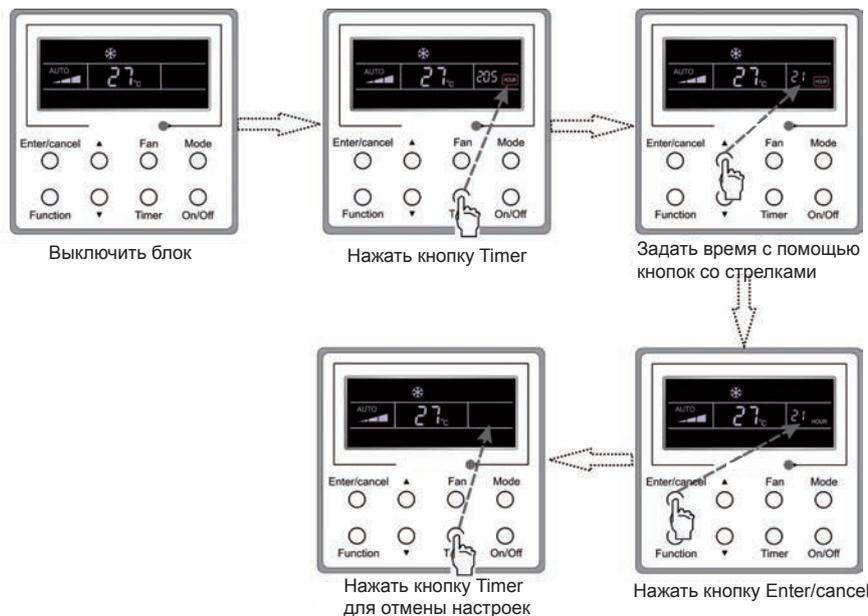
Рис. 8. Последовательность настройки таймера
