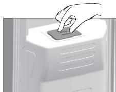
↳ Wenn Sie das neue Gerät zum ersten Mal in Betrieb nehmen, fangen Sie die ersten 1-2 Liter Wasser aus dem neuen Gerät auf und gießen Sie es aus, dann zapfen Sie neues sauberes Wasser zum Trinken.
