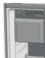
Nehmen Sie den Eisbehälter heraus, heben Sie ihn mit beiden Händen an und ziehen Sie ihn dann heraus; reinigen und trocknen Sie ihn und setzen Sie ihn dann wieder ein.
