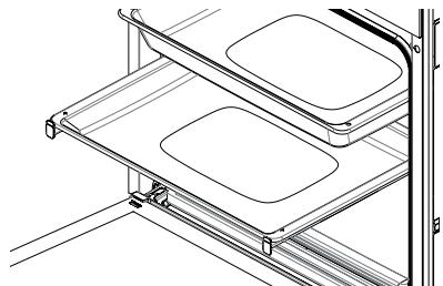
Задвинуть направляющие полностью внутрь, не устанавливая на них предварительно противень или проволочную решетку. Дополнительная принадлежность должна располагаться между передним и задним выступами направляющих.
