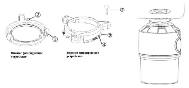
Нижнее фиксирующее устройство устанавливается на оборудование. Верхнее фиксирующее устройство является частью держателя оборудования. Поворачивая нижнее фиксирующее устройство руками, поместите фиксатор нижнего фиксирующего устройства — 2 на крепление держателя — 3. При этом фиксатор 2, должен располагаться на креплении держателя — 3, за отверстием на креплении — 4. Для предотвращения
