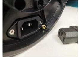
Питание подключается с помощью шнура в разъём внизу оборудование. Оборудование обязательно должно быть заземлено, а в цепь включены устройства, фиксирующие утечку тока.
