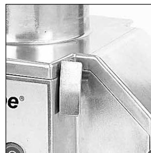
Поднимите головку овощерезки, наклоняя ее назад, чтобы высвободить емкость.
