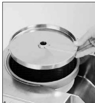
Установите затем соответствующий диск-измельчитель (диск с прямым ножом) и прокрутите его в направлении часовой стрелки, чтобы проверить правильность его установки.
