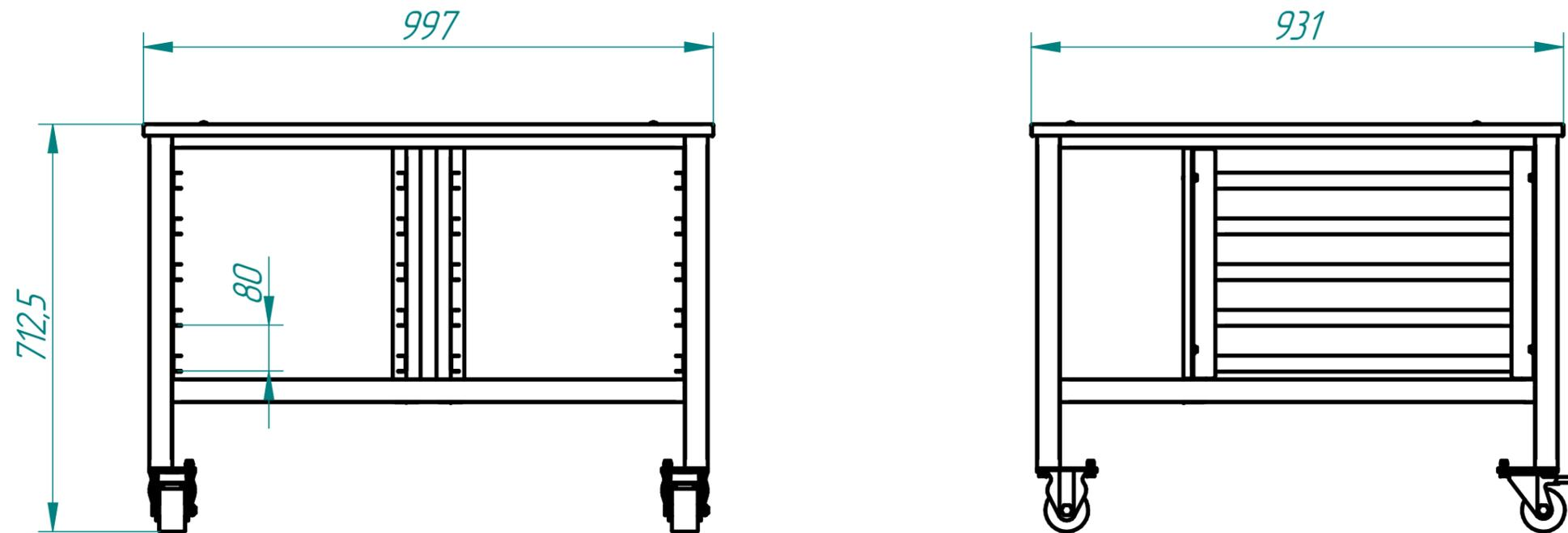
Подставка ПК-10-6/4К является вспомогательным оборудованием. Предназначена для установки ротационно-пекарского шкафа РПШ-10-6/4П и размещения десяти противней 600x400 на держателях полок. Металлические детали подставки изготовлены из высококачественной нержавеющей стали. Благодаря полностью сваренному каркасу, состоящему из прямоугольных и квадратных металлических труб, подставка обладает повышенной жесткостью. Подставка поставляется в собранном виде и имеет колеса.
