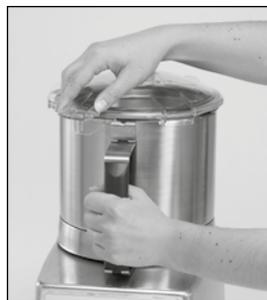
4. Наденьте крышку на чашу и поворачивайте её вправо до тех пор, пока она прочно не зафиксировается.
