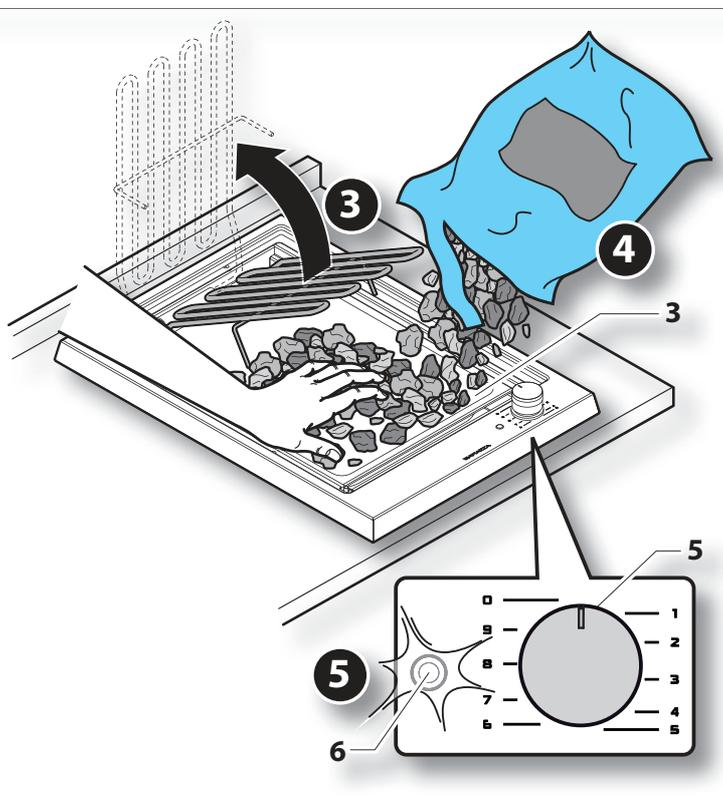
(рис. 9 - дет. 5) Повернуть ручку (5) в желаемое положение (от 1 до 9) в зависимости от приготавливаемого продукта (на стр. 16 представлена таблица с ориентировочными указаниями), включение индикатора (6) указывает на включение устройства и начало нагрева решетки.
