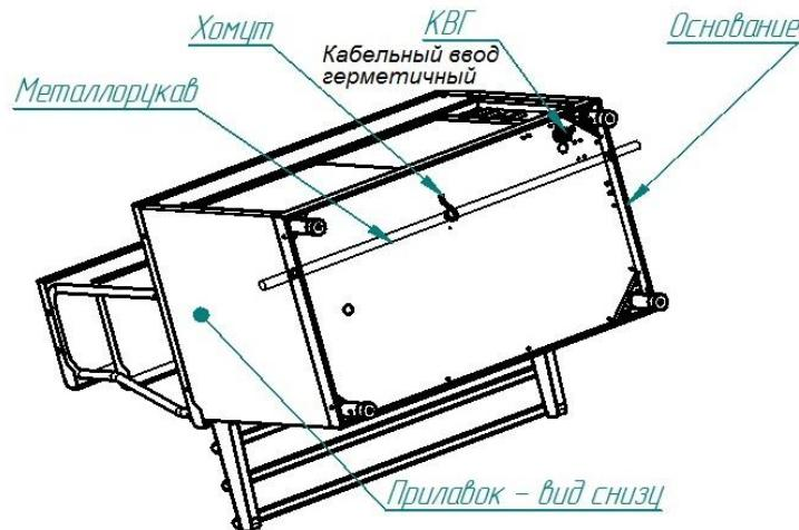
В основаниях изделий линии раздачи введено сквозное отверстие диаметром 29,5 мм и поддерживающие хомуты для возможности проведения металлорукава с питавшими кабелями сквозь все изделия линии раздачи.
