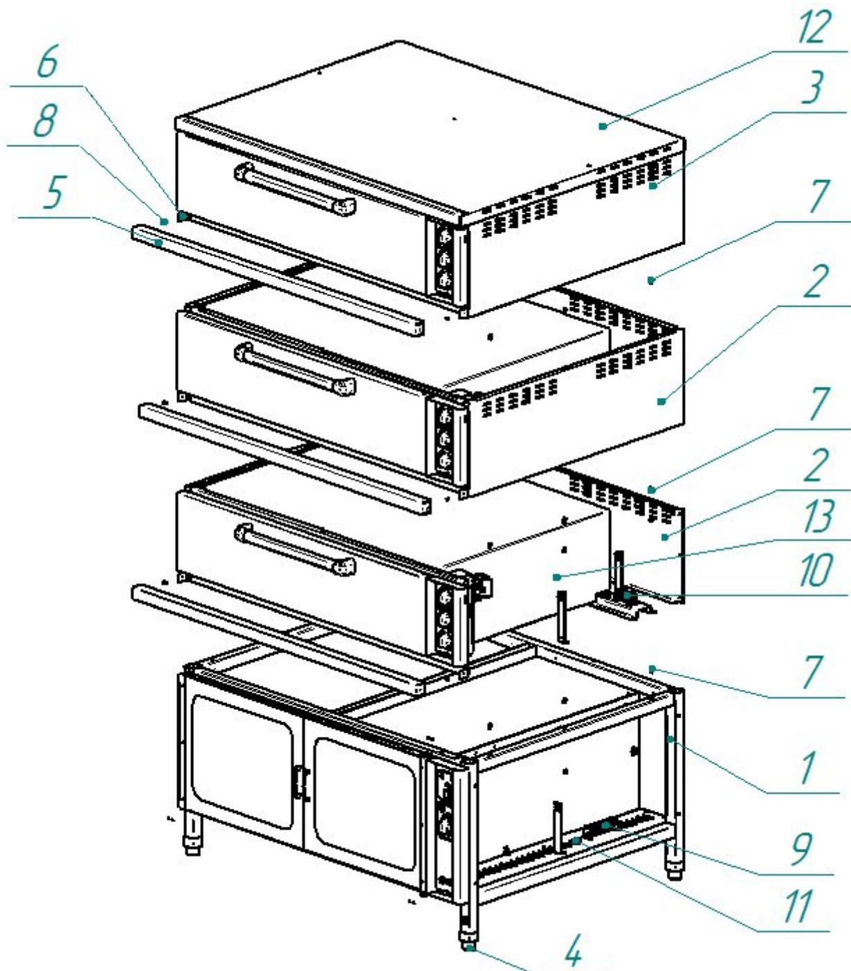
Рис.3 Схема сборки шкафа ШРТ 4-ЭШ + ЭШ-3К
