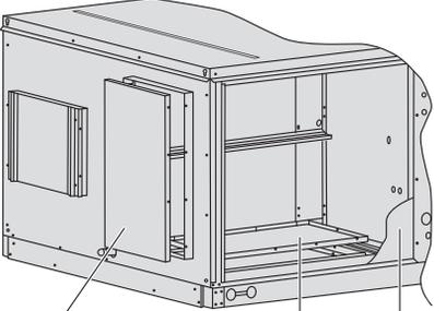
Закройте отверстие для горизонтального возврата крышкой и закрепите его винтами. См. Примечание 2.
