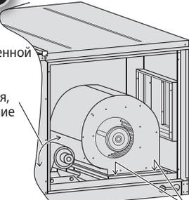
Установите ременной шкив на место. Отрегулируйте натяжение ремня, сдвигая основание двигателя.
