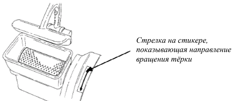
Рис. 10 – Направление вращения вала тёрки
