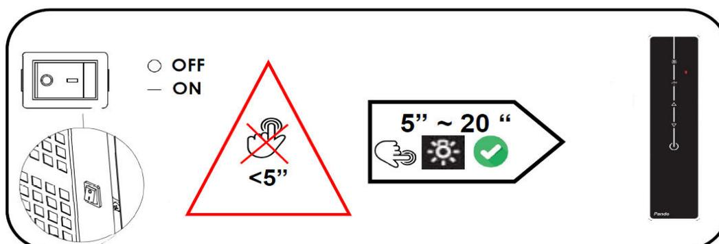
Se demorar mais de 20 segundos para sincronizar o controle, o painel de comando do sino fecha a recepção e não registra nenhum código, você deve repetir o processo, certificando-se de pressionar a tecla entre 5 "e 20".
