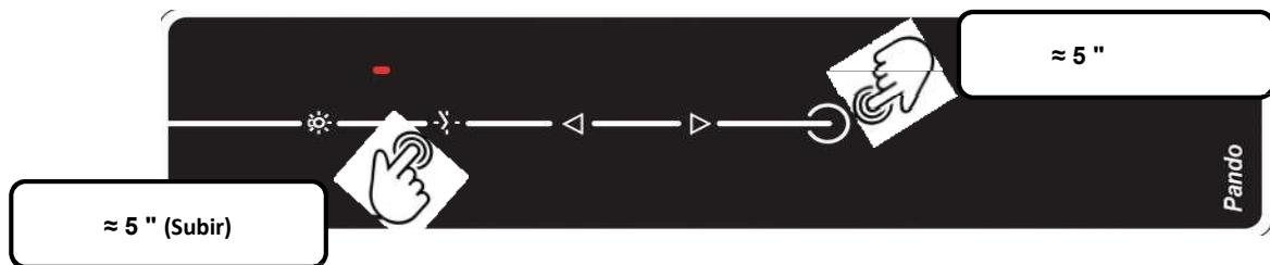
3. No modo de manutenção, durante a subida e descida do módulo do corpo do exaustor que contém os painéis e os filtros, é emitido um sinal sonoro e visual: **o sinal sonoro é um sinal contínuo de 2 segundos com intervalos de 1 segundo**, e o sinal visual é a luz LED de controlo do motor que fica intermitente a cor vermelha.
