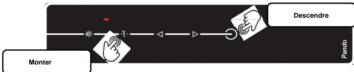
3. Lors du mode entretien, pendant que le module du corps de la hotte qui contient les panneaux et les filtres monte et descend, un signal acoustique et visuel est émis, **le signal acoustique consiste en un beep continu de 2 secondes avec des intervalles de 1 seconde**, et le signal visuel consiste au voyant led de contrôle du moteur qui s'allume en clignotant en rouge.
