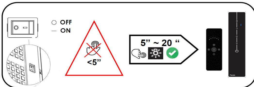
Si on dépasse les 20 secondes pour synchroniser la télécommande, la hotte ferme la réception et n'enregistre aucun code. Alors il faudra répéter le processus, en veillant à appuyer sur la touche entre 5 "et 20".
