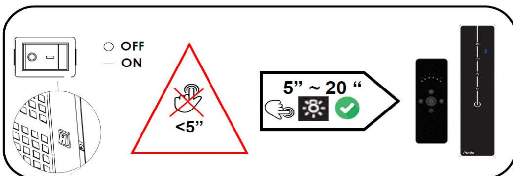
Se demorar mais de 20 segundos para sincronizar o controle, o painel de comando do sino fecha a recepção e não registra nenhum código, você deve repetir o processo, certificando-se de pressionar a tecla entre 5 "e 20".
