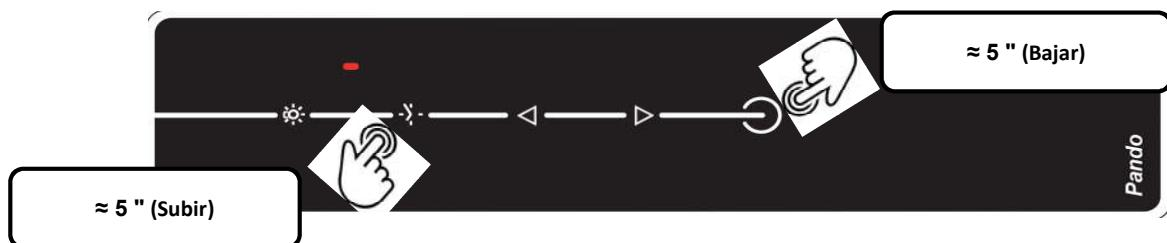
3. En el modo mantenimiento mientras baja y sube el módulo del cuerpo de la campana que contiene los paneles y filtros, se emite una señal acústica y visual, **la acústica es un beep continuo de 2 segundos con intervalos de 1 segundo**, y la visual es el piloto led de control del motor que se enciende parpadeando en color rojo.
