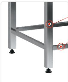
**Ножки- нержавеющая профильная труба квадратного сечения 40x40 мм., толщиной 1,2 мм.**
