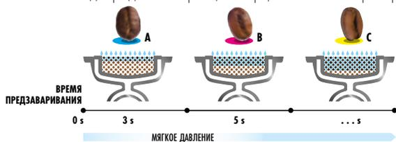
Предзаваривание является первой фазой в приготовлении эспрессо. Его основная функция - насытить и подготовить кофейную таблетку для оптимальной экстракции. Предварительная инфузия также обеспечивает равномерное распределение воды по поверхности кофе и помогает предотвратить образование трещин и каналов.
