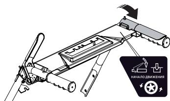
Нажмите на рычаг привода хода по направлению к ручке управления, снегоуборщик начнет движение. Для отключения привода движения отпустите рычаг.
