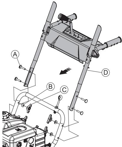
Совместите отверстия нижней и верхней рукояток, и закрепите при помощи болтов и пластиковых барашковых гаек. Используйте крепёжные элементы - бокс №3: (А) болт M8x50 – 4шт.; (В) фигурная шайба – 4 шт.; (С) барашковая гайка M8 – 3 шт. Затяните болты от руки. Закрепите трос привода шнеков.
