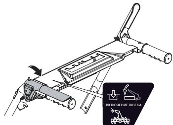
Нажмите на рычаг привода шнека по направлению к ручке управления, шнек начнет вращение и можно начинать расчистку снега. Для отключения шнека отпустите рычаг.
