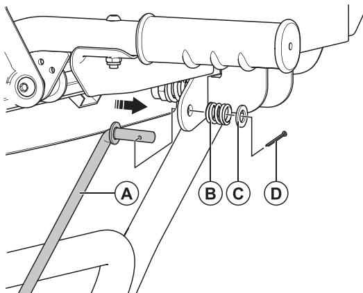
Установите на верхней рукоятке в приемное отверстие рычага переключения передач тягу (A), используйте крепёжные - бокс №11: (B) пружина - 1 шт.; (C) стопорное кольцо - 1 шт.; (D) шплинт - 1 шт.
