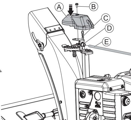
Проденьте рукоятку поворота желоба (A) через хомут (B) нижней рукоятки и установите её в отверстие рулевого механизма, зафиксируйте штифтом. Установите декоративную крышку (A) и зафиксируйте ее. Используйте крепеж из бокса №10: (B) болт M6×12 – 1 шт.; (C) шплинт – 1 шт.
