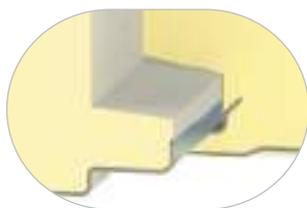
Сэндвич-панели с PIR Premier производятся с уплотнительной ППЭ лентой. При монтаже низкотемпературных камер, чтобы исключить мосты холода, рекомендуется удалить ленту ППЭ и залить в стык монтажную пену. Ленту рекомендуется сохранять для плотного стыка панелей при строительстве среднетемпературных конструкций и холодильных камер.
