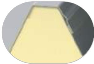
Каплесборник, расположенный в замковом соединении, конденсирует влагу и препятствует ее попаданию внутрь конструкции. Край металлического листа в месте стыка загнут на 180° — такая конструкция обеспечивает монтаж без повреждения поверхности металла и придает соединению дополнительную жесткость.
