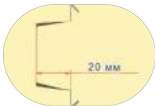
Глубина стыковки по пене составляет 20 мм. Замок «ПрофХолод» — самый глубокий среди российских аналогов, имеет самую большую длину стыка, обеспечивает минимальные тепловые потери соединения.
