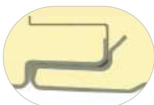
Края металлических листов уходят в пену, придавая панелям дополнительную жесткость. При стыковке панелей по металлическому листу образуется треугольный паз, который фиксирует герметик. Коническая форма металлической обкладки замка направляет панели при стыковке.
