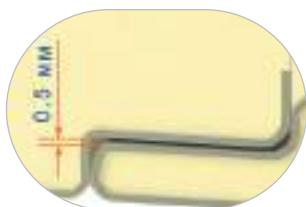
Стыковочный замок выполнен с повышенной точностью. Зазоры менее 0,5 мм минимизируют тепловые потери и расход монтажных материалов. Края металлических листов уходят в пену, обеспечивая монолитность и жесткость конструкции.
