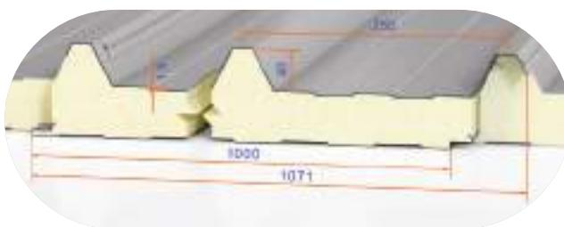
Кровельные сэндвич-панели с одной стороны имеют ребра жесткости в виде выступов трапециевидной формы высотой 40 мм, с другой стороны — микропрофиль глубиной 1,5 мм.
