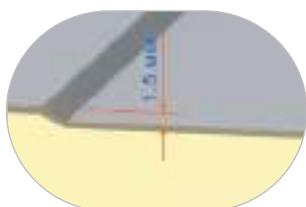
Микропрофиль глубиной 1,5 мм обеспечивает панелям максимальную жесткость.
