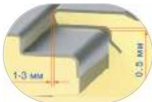
Стыковочные зазоры не более 0,5 мм минимизируют тепловые потери конструкции и расход монтажных материалов. Внешний стыковочный зазор препятствует разрушению конструкции при тепловом расширении и составляет 1-3 мм.
