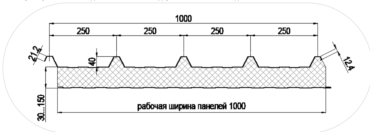
Рисунок 21. Геометрия кровельной сэндвич-панели со стандартным замковым соединением
