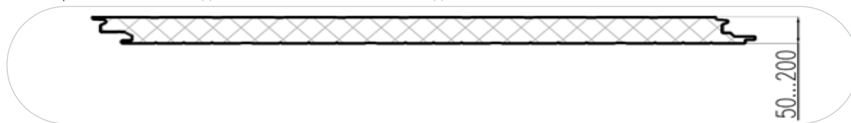
Рисунок 19. Геометрия стеновой сэндвич-панели с замковым соединением Z-Lock (ПСТ Z)
