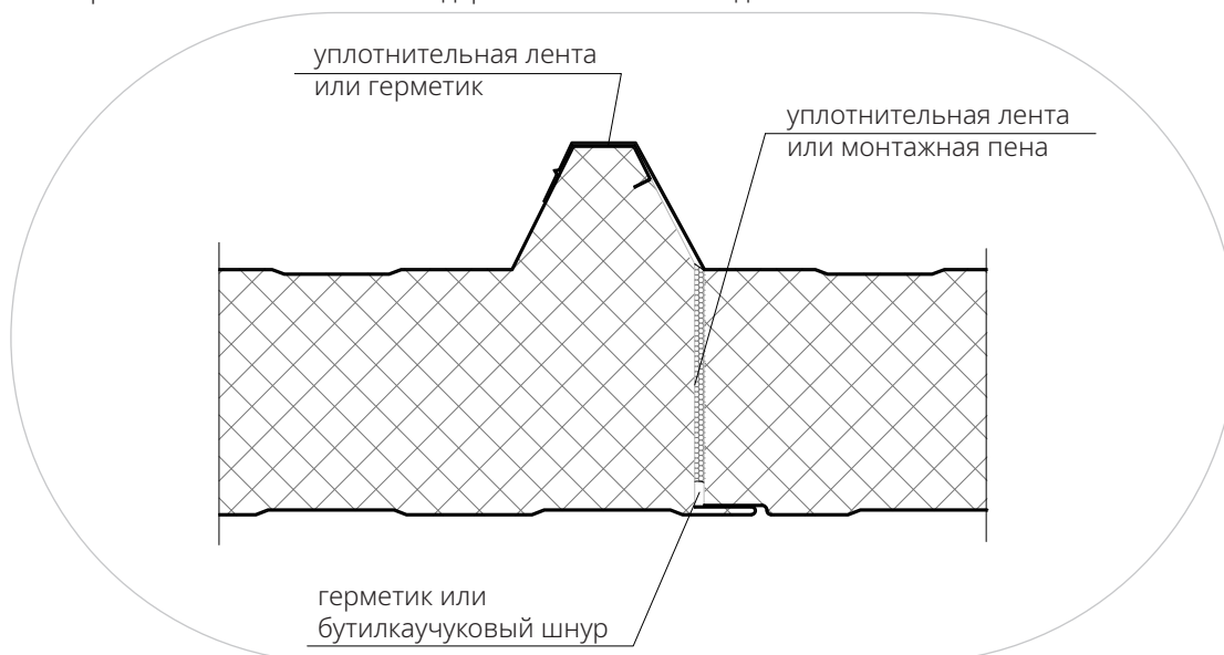
Рисунок 22. Стык кровельных панелей со стандартным замковым соединением
