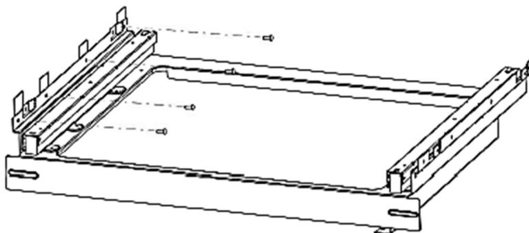
Б. Метод крепления к полке снизу.
