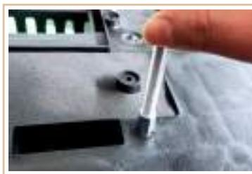
3. Затягивание монтажных винтов
