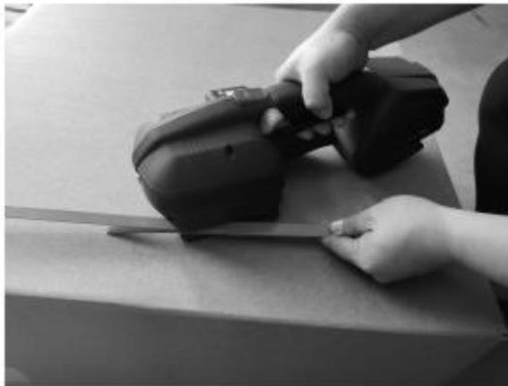
Рис 4 Произвести установку оборудования, установить ленту в оборудование.
