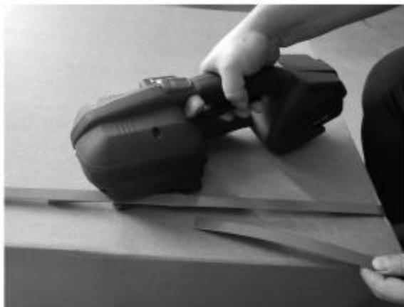
Рис 7. После завершения, произвести поднятие рукояти 3.отвести в сторону корпус оборудования
