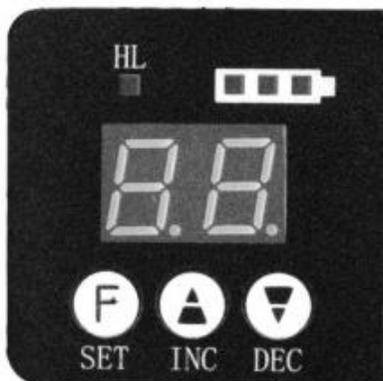
Рис 2. Панель управления, Индикатор питания аккумулятора
