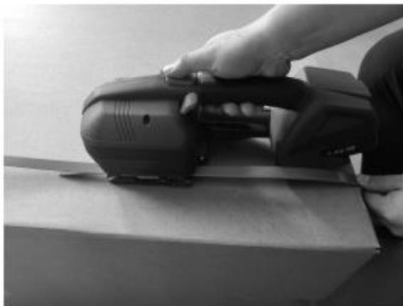
Рис 5 Активировать кнопку натяжения ленты, при этом стреппинг оборудование произведет натяжение полотна ленты относительно нижней ленты. Натяжение ленты прекратиться при отпускании клавиши. В процессе натяжении индикатор сигнализирует о данном действии и горит синим цветом. При натяжении корпус и лента может смешаться, удерживайте корпус в нужном направлении.
