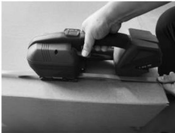
Рис 6. Сварка и обрезка ленты, с помощью рычага 4. Индикатор сварки будет гореть фиолетовым цветом, по завершению процесса сварки индикатор будет гореть зеленым цветом.
