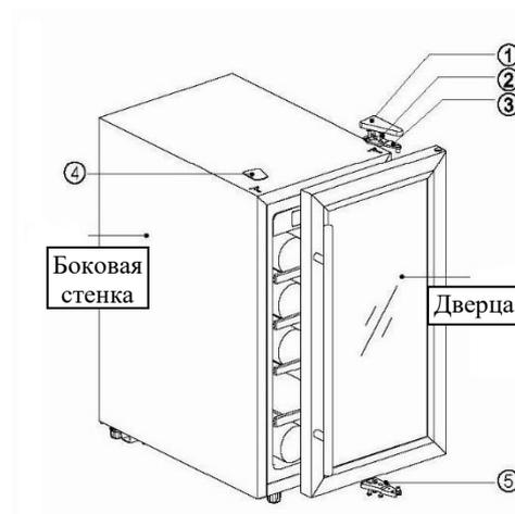
Установите нижнюю дверную петлю ⑤ в нижний левый угол. Наденьте дверь на нижнюю дверную петлю.
