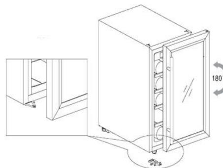
Установите дверную петлю в верхний левый угол и закрутите фланцевые винты ②. Наденьте крышку дверной петли ①. Наденьте заглушку с правой верхней стороны ④.
