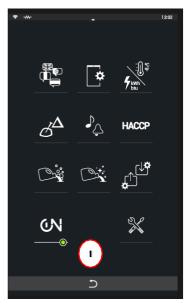
Чтобы подключить печь к Fagor Connect, перейдите в раздел Настройки (1) и активируйте доступ к интернету вещей (2). Кабель должен быть подключен, а на значке должен гореть зеленый индикатор.
