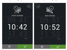
В обоих случаях, после подтверждения настроек всё управление отключается и на экрана выводится время до начала приготовления. Отключить отложенный старт можно кнопкой отмены.
