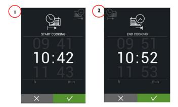
При отложенном старте управление блокируется, и на экране показывается только время до начала приготовления. Эту функцию можно отключить кнопкой отмены и вернуться на основной экран ручного режима приготовления.
