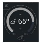
В режиме **Дельта** управление происходит за счет постоянного увеличения температуры. Заданная температура равна сумме выбранной пользователем температуре на щупе и разнице температур, заданной в этом разделе.
