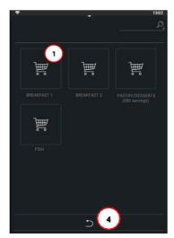
При выборе одной из тележек покупателя (1), запускается функция **Multitray** и каждый рецепт загружается на соответствующий противень (2). Расположение противней повторяет заданное при сохранении этой тележки.
