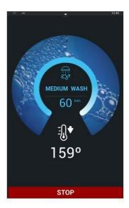
Если температура в камере поднимается выше 65 °C, то автоматически включится охлаждение.
