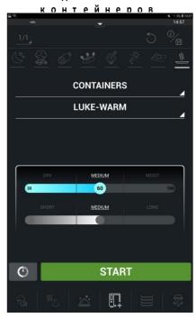
Подача из контейнеров используется для восстановления предварительно разогретых продуктов. В ходе такого восстановления контролируется внутренняя температура продукта.
