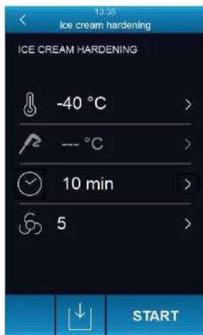
Цикл представляет собой шоковую заморозку с контролем времени. По истечении установленного времени устройство не переходит в режим хранения, цикл закаливания продолжается до нажатия клавиши **STOP**
