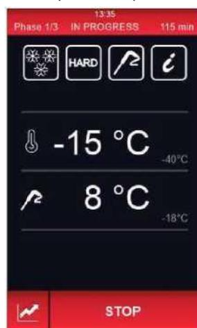
На экране отображаются параметры текущего цикла. При нажатии на область температуры экран переходит в меню, в котором можно редактировать значения текущего цикла.
