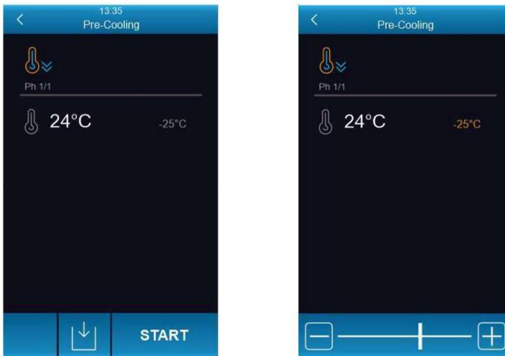
Установите необходимое значение и нажмите на область **START**, чтобы запустить цикл предварительного охлаждения камеры. Отобразится следующий экран цикла предварительного охлаждения.
