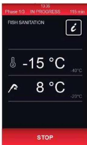
Нажатие кнопки **START** запускает цикл санитарной обработки.
