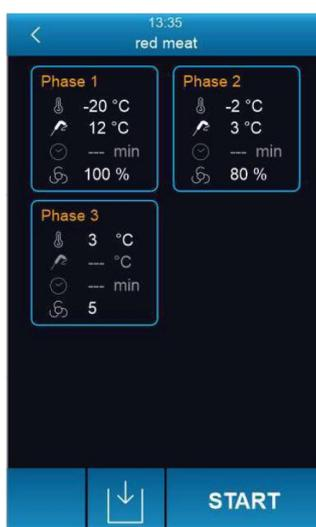
При использовании циклов с контролем температуры проводится тест для проверки правильности введения термощупа в продукт, подлежащий шоковой заморозке. Если тест не будет пройден успешно, цикл автоматически переводится в режим времени, раздается звуковой сигнал и отображается значок предупреждения об опасности.
