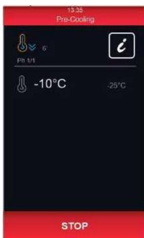
Нажмите кнопку **STOP**, чтобы выйти из режима предварительного охлаждения. После достижения заданного значения температуры в камере раздается звуковой сигнал, цикл продолжится, температуру в камере поддерживается до тех пор, пока не будет нажата кнопка **STOP**. Контроллер автоматически вернется в главное меню.
