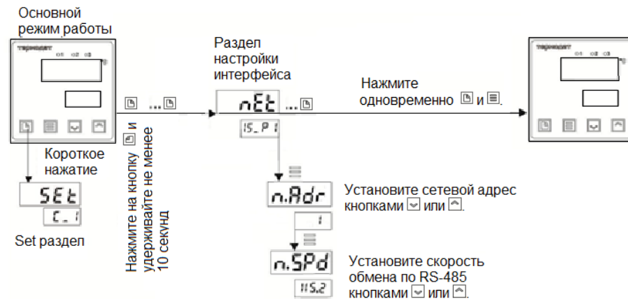
Рис. 13. Установка сетевого адреса сейфа-термостата.
