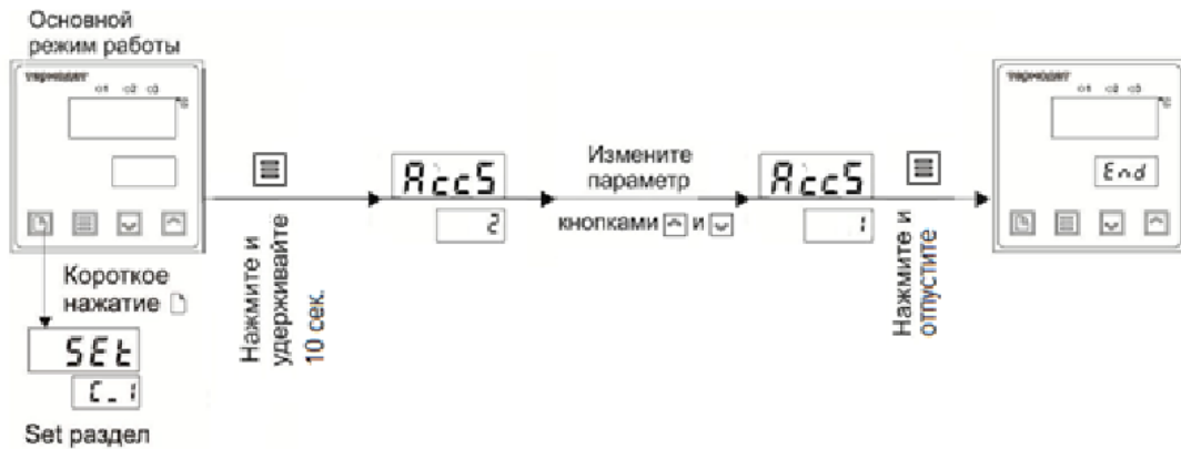
Рис. 11. Схема ограничения случайного изменения сценария работы изделия
