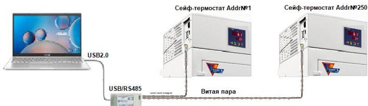
Рис. 14. Подключение интерфейса сейфов-термостатов к ПК
