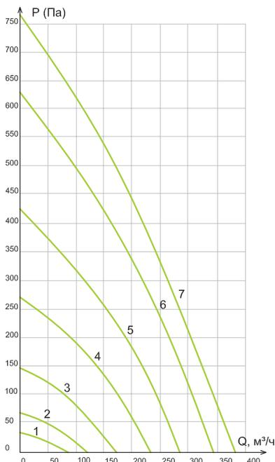
На графиках указаны кривые падения давления для скоростей вентилятора 1-10 для автоматике GTC и скоростей 1-7 для автоматике ZENTEC.
