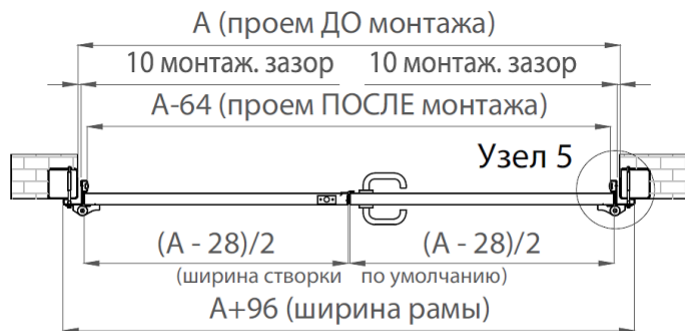
Рисунок 149: Разрез 1-1 Крепление «угловой» рамы к кирпичу
