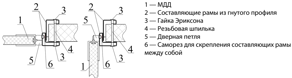
Рисунок 107: Узлы крепления металлической рамы «в обхват» слева — Узел 1, справа — Узел 2
