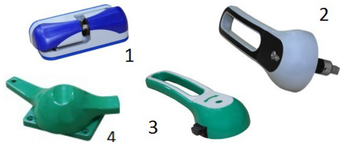
Рисунок 27: Фурнитура серии R (Rahrbach): 1 — дверная металлическая петля с регулировками в 3-х плоскостях; 2 — наружная поворотная ручка со встроенным замком; 3 — внутренняя поворотная ручка аварийного открывания; 4 — дополнительный затвор для дверей более 2400мм по высоте.
