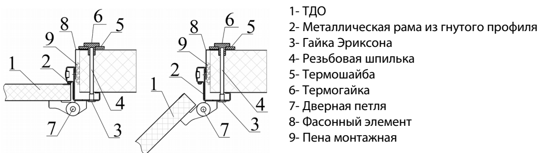
Рисунок 123: Узлы крепления металлической «Угловой» рамы к сэндвич панели слева — Узел 1, справа — Узел-2
