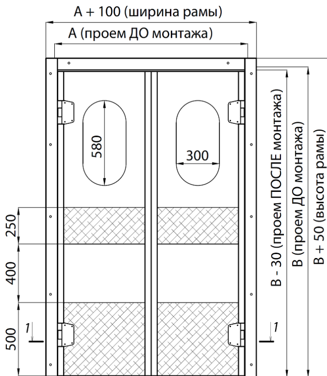
Рисунок 104: МДД с рамой «в обхват»
