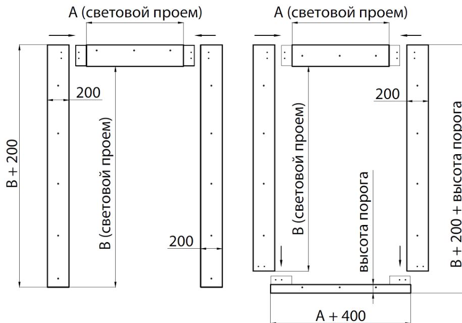
Рисунок 64: Металлическая накладная рама для ОД легкой серии. (слева вариант без порога, справа - с порогом).
