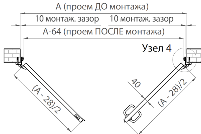
Рисунок 149: Разрез 1-1 Крепление «угловой» рамы к кирпичу
