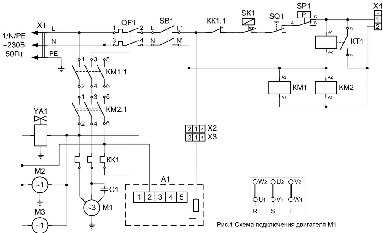
Рис.1 Схема подключения двигателя М1
