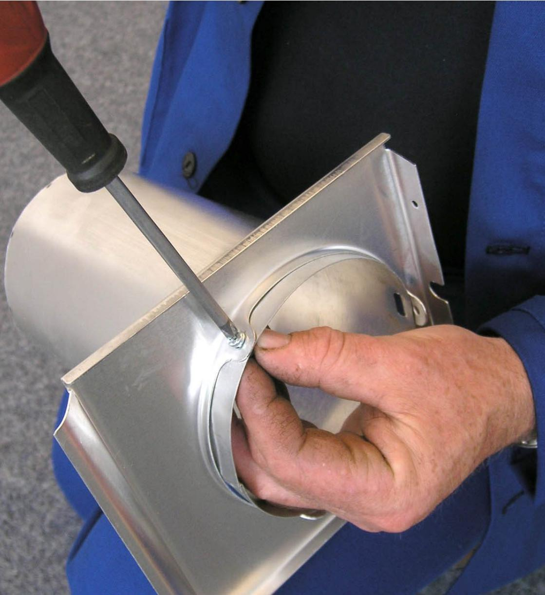
На отверстия во всасывающей трубе прикрепить фланцевую корзину выхода.
