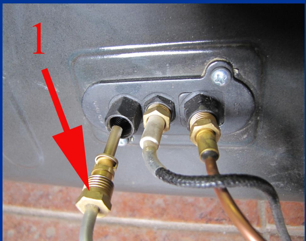
\* Рекомендуется перед откручиванием штуцера запальника смазать штуцер и алюминиевую трубку около штуцера (WD 40) или любой жидкой смазкой для предотвращения разрушения.
