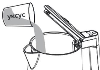
2. Налейте необходимое количество средства для удаления накипи, добавьте воды до отметки MAX и после закипания оставьте раствор в чайнике более 1 часа.
