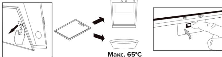
**Алюминиевые фильтры:** Во избежание возгорания тщательно очищайте их раз в месяц или каждый раз, когда загорается индикатор на дисплее (если он установлен). Для этого снимите фильтры и замочите их в горячей воде с моющим средством на час. Если вы используете посудомоечную машину, расположите фильтры вертикально, чтобы улучшить процесс очистки.
