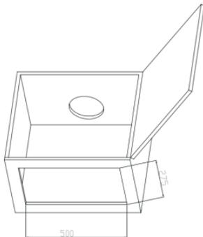
Установите размер шкафа в соответствии с размером корпуса вытяжки. Просверлите четыре отверстия диаметром 6 мм в нижней части шкафа в соответствии с расположением 4 отверстий в верхней части вытяжки и сделайте квадратное отверстие для выхода воздуха.
