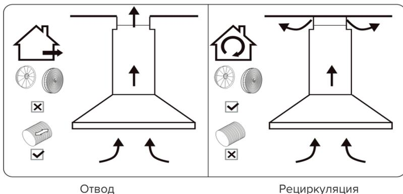
Если у вас есть выход наружу, вытяжку можно подключить, как показано на рисунке выше, с помощью трубы (с внутренним диаметром 150 мм).
