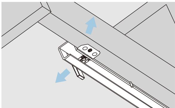
Вытянуть пластиковые стопорные штифты, приподнять ящик и потянуть на себя.
