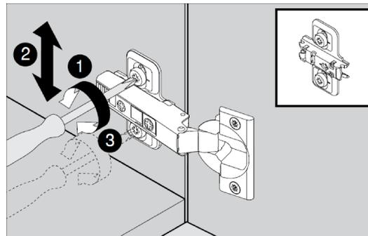
Регулировка по глубине
