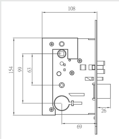
Корпус замка выполнен в соответствии со стандартами ANSI. Изготовлен из высококачественной нержавеющей стали марки SUS304. Фронтальная планка 224 X 25 мм с закруглёнными краями.
