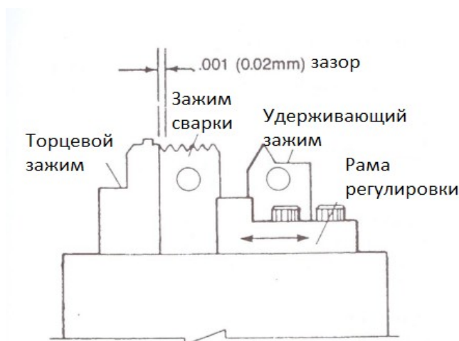
Рисунок 24 Зазор между зажимом сварки и торцевым зажимом
