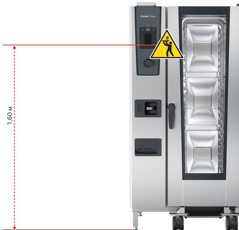
Если Ваш аппарат установлен таким образом, что верхний уровень загрузки находится на высоте более 1,60 м над полом, на этом месте необходимо закрепить входящий в комплект поставки предупреждающий знак.
