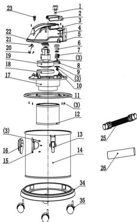
Установите фильтр (12) на верхнюю часть пылесоса. Установите верхнюю часть пылесоса на бак (14). Закройте защелки (13). После длительного использования фильтр следует вынуть и продуть сжатым воздухом.
