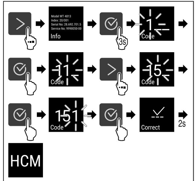
Fig. 6 Доступ при помощи числового кода **151**
