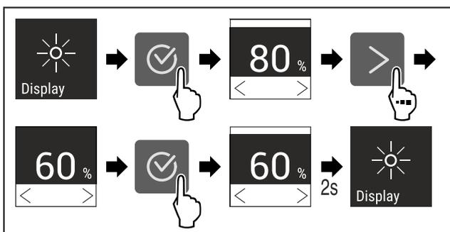
Fig. 82 Примерное изображение: переключение с 80 % на 60 %.
