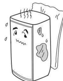
Плохое рассеивание тепла, проверьте, достаточно ли места вокруг устройства для охлаждения.
