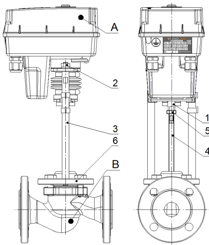
Рисунок 3 – Монтаж электропривода в столбчатом исполнении
