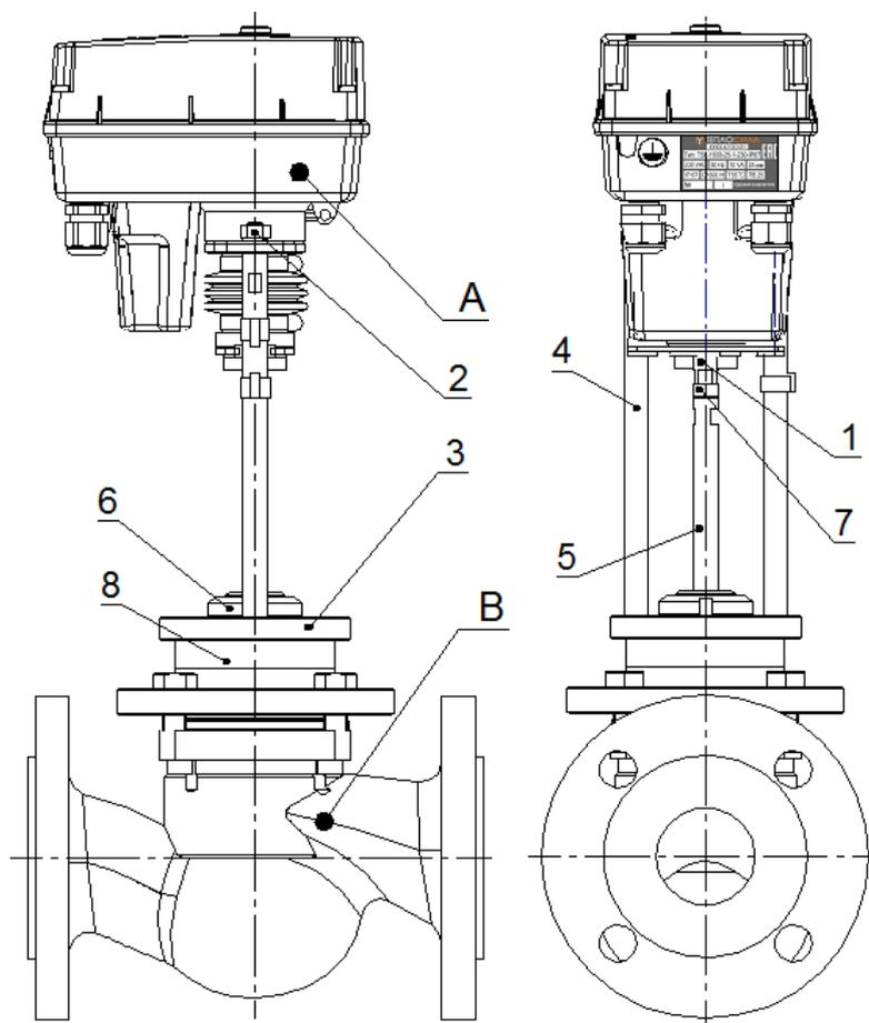
Рисунок 4 – Монтаж электропривода во фланцевом исполнении
