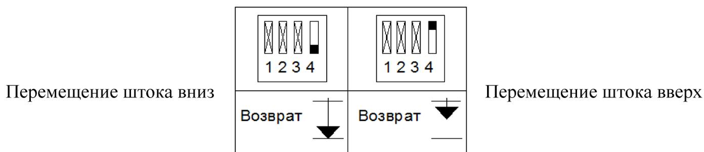
Рисунок 7 – Настройка направления работы функции безопасности
