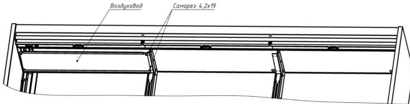
**14. Наживить профиль на саморезы, отодвинуть в крайнее левое положение, вставить сотовую панель и прижать профилем. Саморезы затянуть.**
