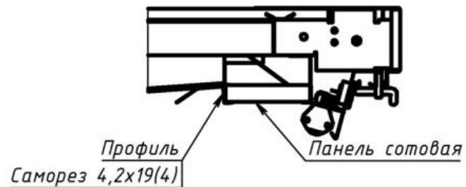
**16. Навесить задние перфорированные стенки на стойки витрины.**
