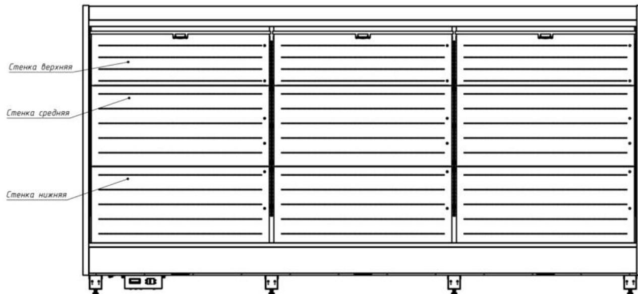
**17. Установить швеллеры, вставив их в пазы передней стенки спереди и пазы кожуха вентиляторов сзади.**
