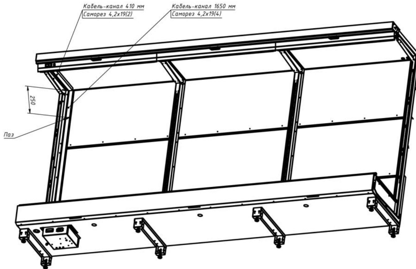
**10. Произвести протяжку провода освещения, датчиков температуры контроллера и термометра через кабель канал.**
