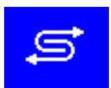
Если необходимо наполнить пустой контейнер для соли, на экране отображается следующий рисунок (► 10.1). Индикация исчезнет после наполнения контейнера для соли, когда будет выполнено примерно 3 цикла мойки и часть добавленной соли растворится.
