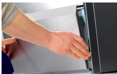
Снимите переднюю обшивку
