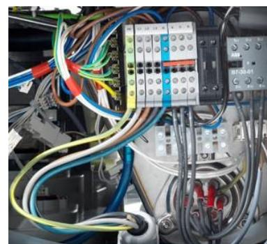
Подсоедините кабель сетевого питания в соответствии со схемой подключения к клеммам PE-N.
