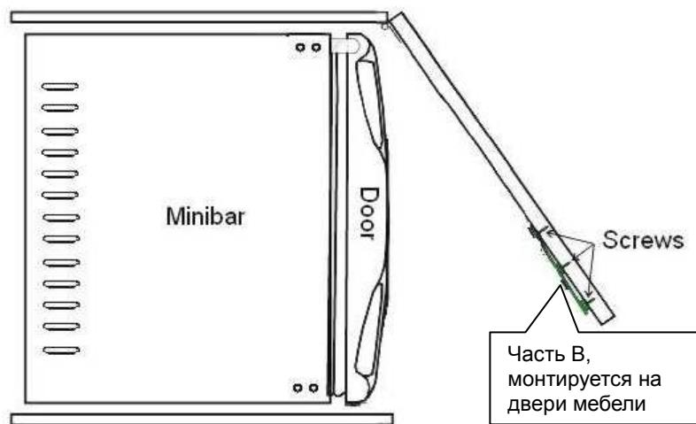
**Шаг 2:** Зафиксируйте часть А на дверь минибара двумя винтами. Убедитесь, что часть А скользит хорошо по части В.
