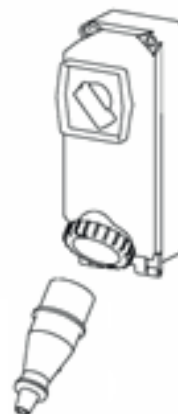
Рис. 6.2.2. – Блок управления электропитанием выключен
